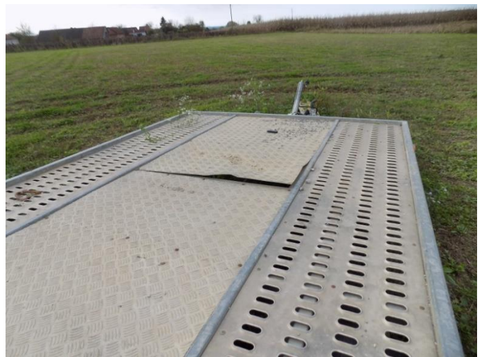
4. Prikolica LORRIES – oštećenje karoserije
