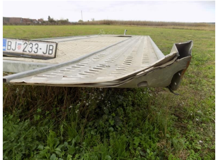
2. Prikolica LORRIES – oštećenje karoserije
